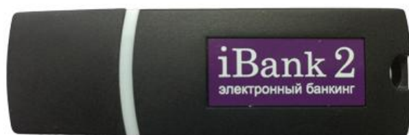
Рис. 1. USB-токен «iBank 2 Key», исполнение корпуса «А»
